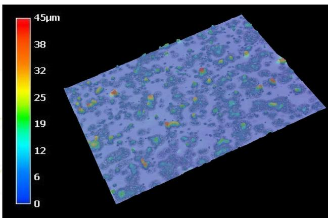
IMAGEM MICROSCÓPICA DE UM REVESTIMENTO POR PULVERIZAÇÃO
